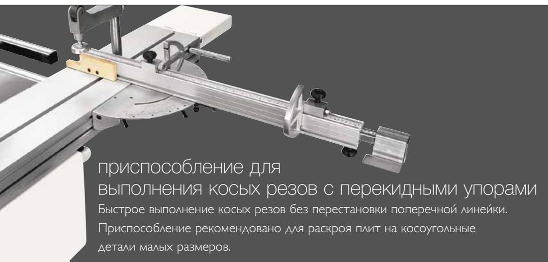
приспособление для выполнения косых резов с перекидными упорами
