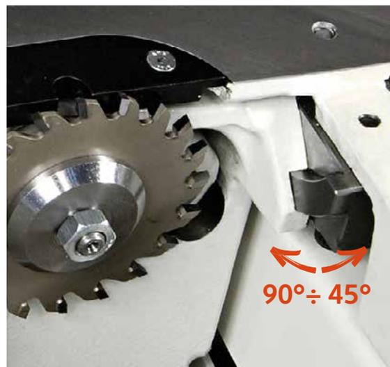
Подрезная пила регулируется с внешней стороны без использования ключей. Система не имеет люфтов и позволяет настраивать узел быстро и точно.
