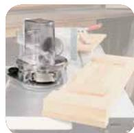
**Направляющая для криволинейного фрезерования**
