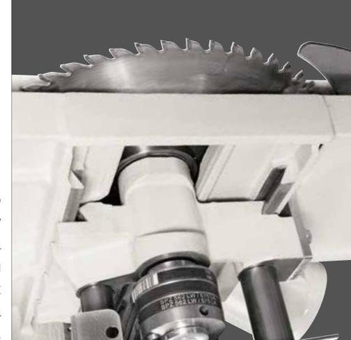
Оси вращения поворотной части имеют диаметр 120 мм и опираются на две промежуточные дуговые направляющие, закрепленные на станине. Такое решение характеризуется повышенной жесткостью и долговечностью.
