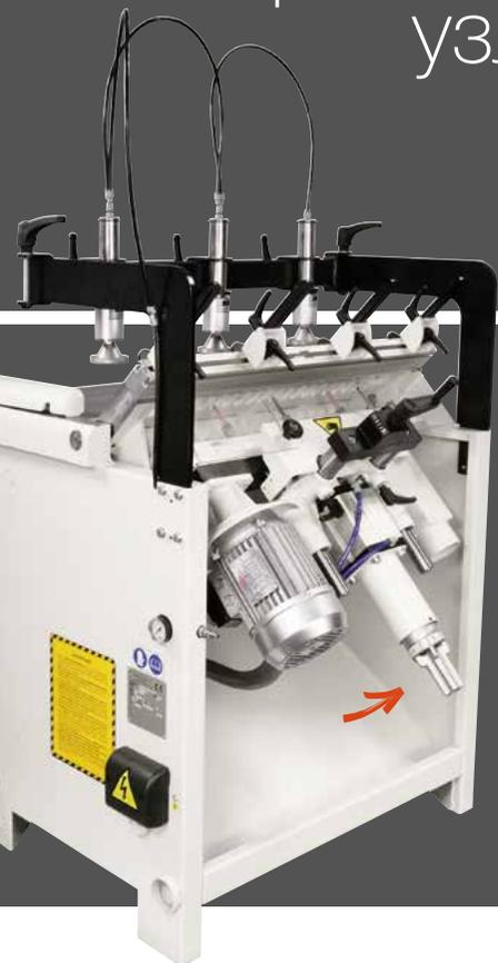
Идеальное качество при сверлении отверстий в горизонтальном и вертикальном направлении и под углом 45°.
