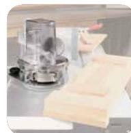
**Направляющая для криволинейного фрезерования**
