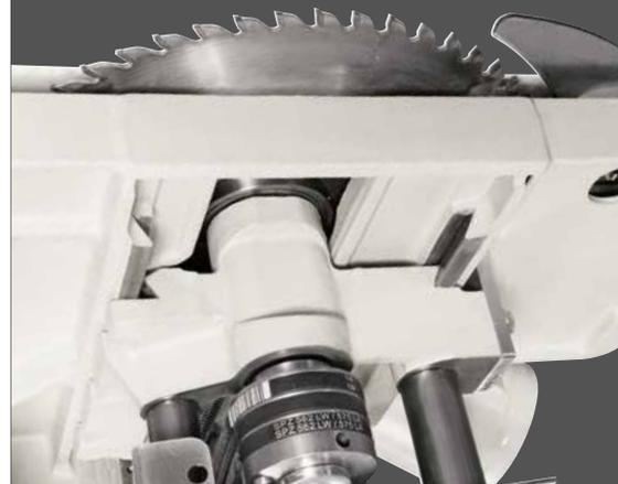
Оси вращения поворотной части имеют диаметр 120 мм и опираются на две промежуточные дуговые направляющие, закрепленные на станине. Такое решение характеризуется повышенной жесткостью и долговечностью.
