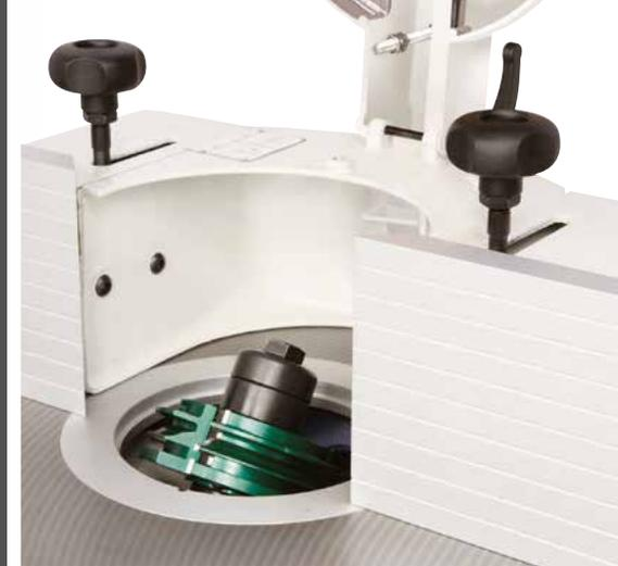
Модели **st 3** и **t 45 w classic** могут комплектоваться опциональным фрезерным узлом с наклоняемым шпинделем (на угол до 45° к задней стороне станка).
