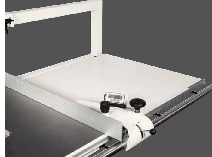
цифровой индикатор положения на параллельной линейке
