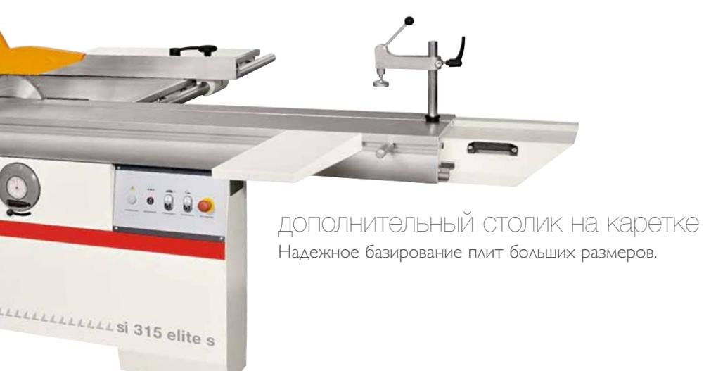
дополнительный столик на каретке. Надежное базирование плит больших размеров.
