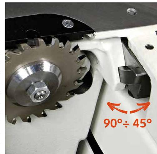
Подрезная пила регулируется с внешней стороны без использования ключей. Система не имеет люфтов и позволяет настраивать узел быстро и точно.
