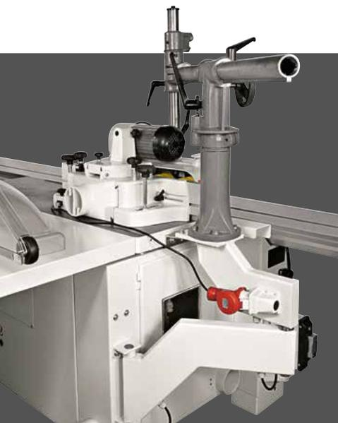
электрическая подготовка и отводимый штатив для автоподатчика
