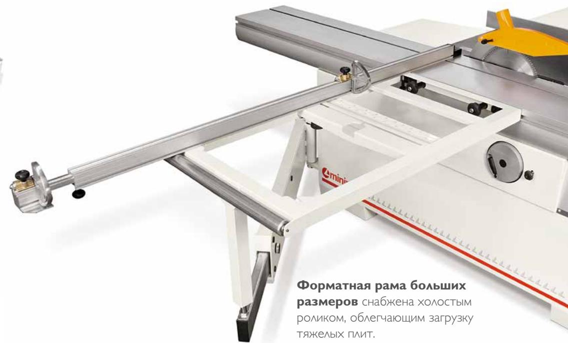
**Форматная рама больших размеров** снабжена холостым роликом, облегчающим загрузку тяжелых плит.
